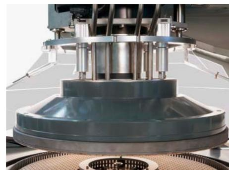
Ausrichtsystem ermöglicht Be- und Entladung im Spalt
