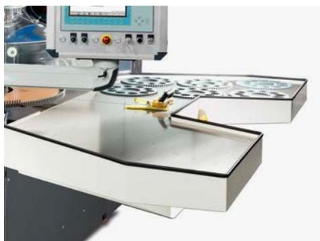
AC 880-F Spaltladetisch für eine komfortable Maschinenbedienung
