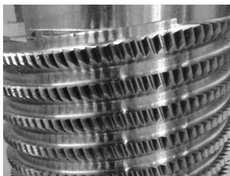
Werkstück mit verdrehter Spannute
