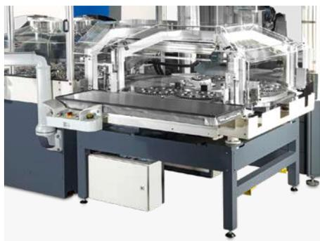
Twin Loader – automatischer Läuferscheibenaustausch für kürzeste Ladezeiten
