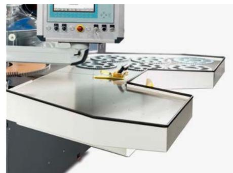
AC 1000-F Spaltladetisch für eine komfortable Maschinenbedienung
